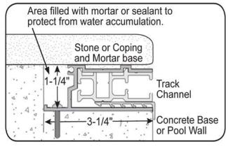
TRACK CHANNEL ON TOP OF BEAM FILLED BEHIND TRACK CHANNEL
